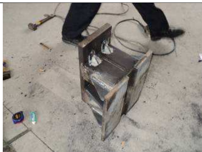
Photo 15: Jetzt hat Robinson die Reitstockkonsole noch fertig geschweisst, ja das macht er sehr gerne. Wir müssen sehr darauf achten, dass sich die Lehrer nicht immer nur die schönsten Arbeiten angeln. Die Lehrer überlassen dann Lehrlingen die nicht so schönen Arbeiten.
