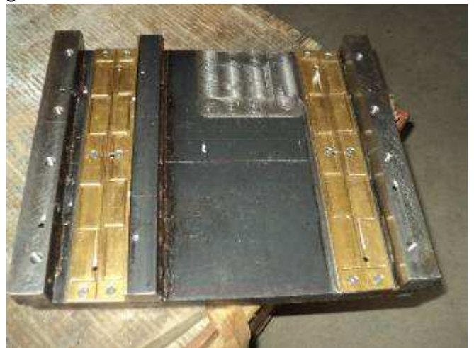
Photo 04: Dieser Schlitten hat viele Schmierbohrungen. Wir haben jetzt auch noch eine Änderung entschieden, damit besser geschabt werden kann. Das geht ja gut, die Zeichnungen werden sofort geändert.
