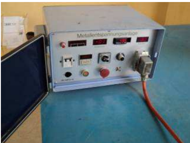
Photo 18: Dies ist eine alte Wiap LC 20 Metallenspannungsanlage, die wir von einem Schweizer Kunden zurückkauften, als er die Produktion änderte. Was täten wir ohne Vibrieren!
