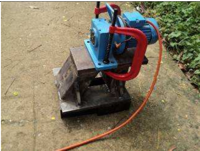
Photo 17: Wir machen es im Freien, weil der Hallenboden nicht gut genug ist. Der Hallenboden vibriert zu stark. 30 Minuten auf 4300 Umdrehungen wird entspannt.
