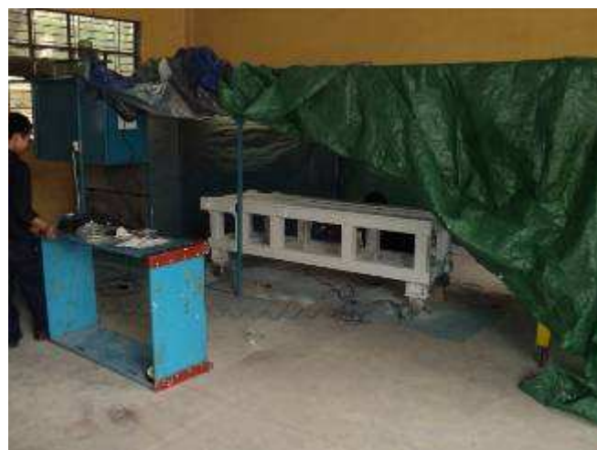
Photo 7: Hier mussten wir die Spritzkabine improvisiert vergrößern; das Bett ist einfach zu lange. Wir werden nach den Sommerferien einen andockbaren Kabinenteil machen. Das wird eine schöne Arbeit, auch für die neuen Lehrlinge.
