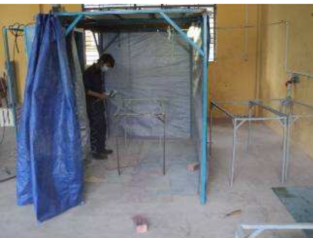
Photo 14: Wir haben nur eine einfache, selbstgebaute Spritzkabine. Die Absaugwand kauften wir in der Schweiz, aber es hilft schon recht, dass man gut spritzen kann.
