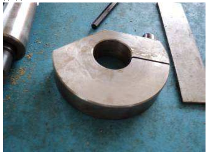
Photo 17: Dies ist der Excenter für unsere neue, kleine Metalltensionsanlage LC 05. Wir machen hier in Vietnam das erste Modell. Es ist interessant, wenn die Lehrlinge Arbeiten machen können, die sie/wir auch brauchen können.
