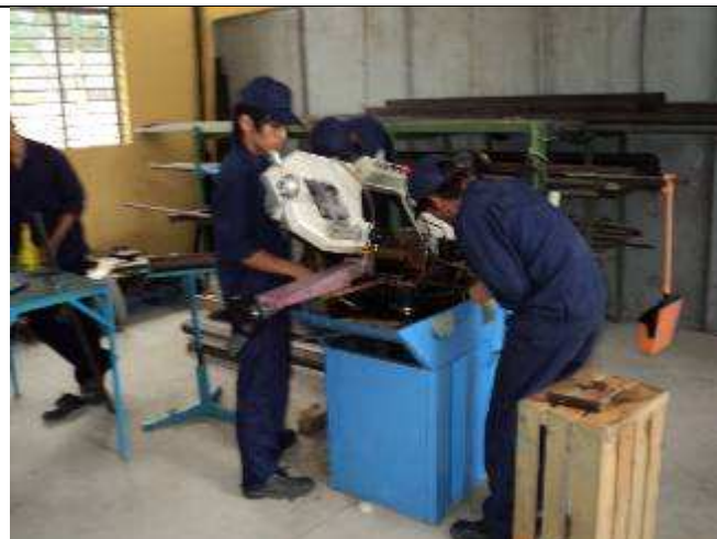
Photo 9: Man sägte 2 Tage ohne Kühlmittel. Was da heraus kam, alles verrostet. Wir waren schon enttäuscht, dass die Lehrer so was zugelassen haben, resp. wussten sie es nicht?
