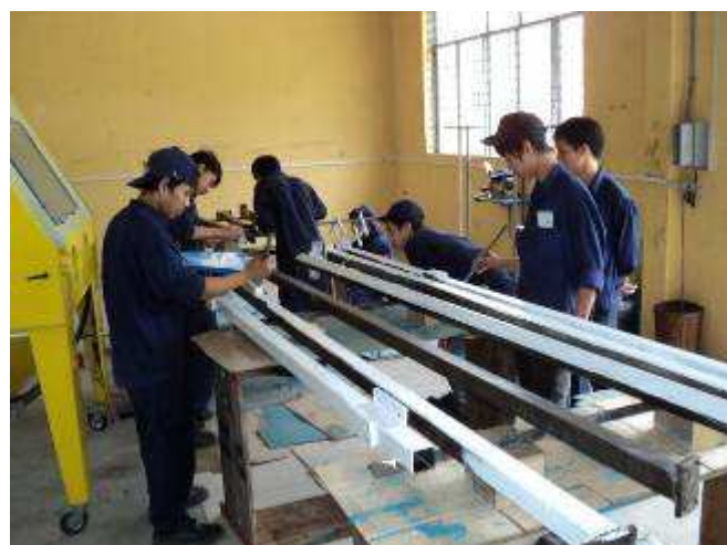
Photo 18: Unsere Spritzkabine ist zu klein fur diese langen Teile, nun wird eben von Hand gemalt
